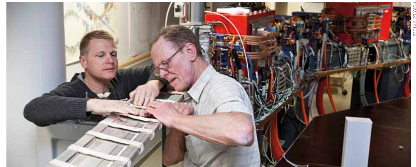
▲ En avanceret partikelaccelerator er ikke ligefrem en hyldevare, så ASTRID2 er i vidt omfang designet og konstrueret af instituttets egne medarbejdere. Her er forskningstekniker Henrik Juul (t.v.) og fysiker Niels Hertel i gang med at føje endnu en del til ringen.
