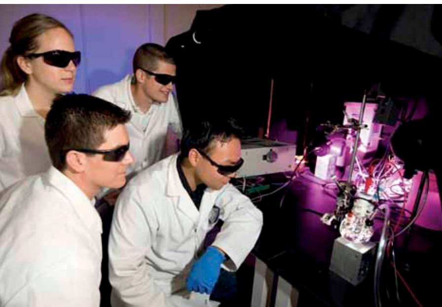
Jakob Kibsgaards forskerteam på Stanford i gang med at karakterisere materialers evne til at absorbere "sollys" fra en Xenon lampe, hvis stråler ligger så tæt på solspektret som muligt. Forrest: Professor Thomas Jaramillo og Zhebo Chen, bagerst Blaise Pinaud og Jakob Kibsgaard.
