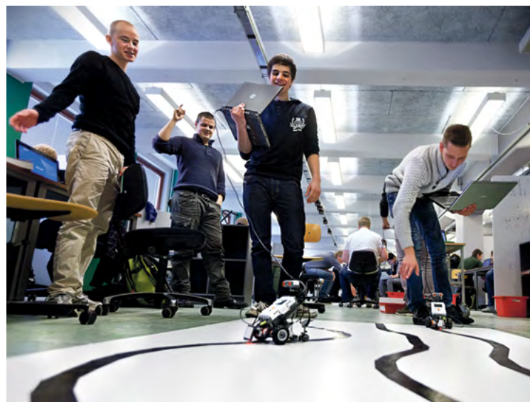
Der er kapløb mellem robotterne fra LEGO Mindstorms-serien, som de studerende har programmeret til at følge den sorte linje på underlaget.
